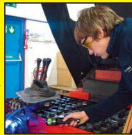
Die Anlage wird entweder mit einer UV- oder einer UV-/Blaulicht-Kontrollleuchte von Spectroline gescannt.
