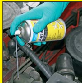
Nach der Reparatur werden die übrigen Farbstoffe von den Leckstellen beseitigt.
